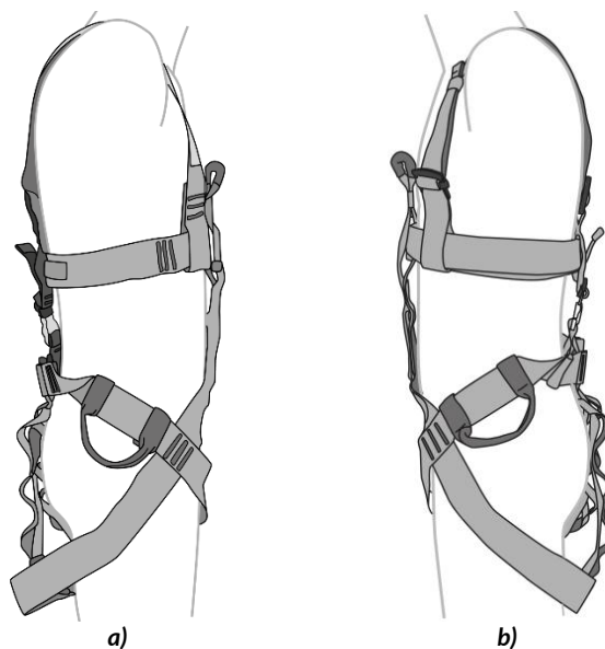
Rys. 4 Uprząż asekuracyjna Build Master założona na manekinie; a) – widok od strony prawej, b) – widok od strony lewej
